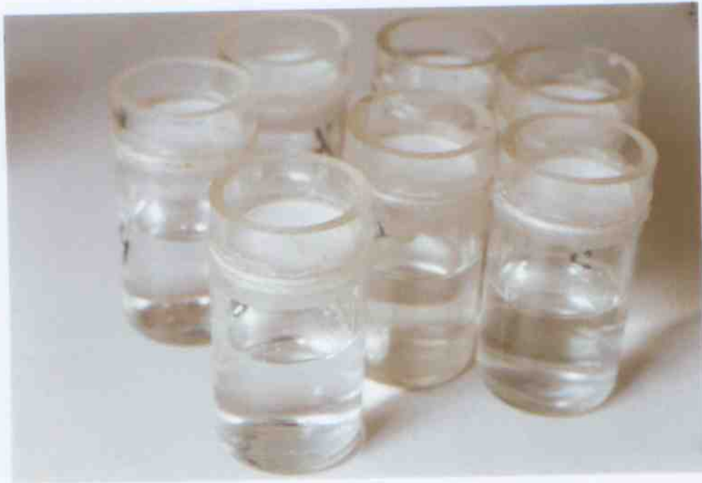
Fig. 1: Assemblage des éprouvettes pour la détermination de la perméabilité à la vapeur d'eau
